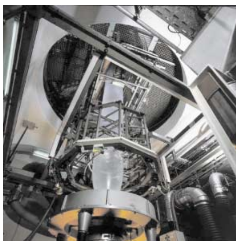
Abbildung 3. Folienblasen aus aliphatisch-aromatischem Copolyester (Ecoflex). Foto: BASF AG.
